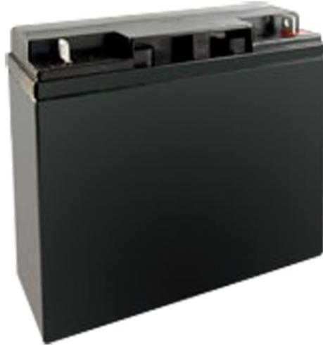
Batteria al piombo in tecnologia AGM. 12 VDC / 18Ah. Ogni singola cella della batteria è dotata di una valvola di sicurezza unidirezionale che garantisce lo smaltimento di eventuali sovrappressioni di gas interni. Dimensioni: 181x168x76 mm. Peso 5,5 kg.
