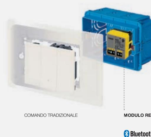
Per favorire la conversione di un impianto elettrico di tipo tradizionale in un impianto connesso, in particolare se realizzato a pulsanti e relè, sono disponibili i **moduli connessi** da retrofrutto per relè luce e per tapparelle. Sia il relè per le luci che l'attuatore per le tapparelle possono essere installati a retrofrutto o in scatola di derivazione.
